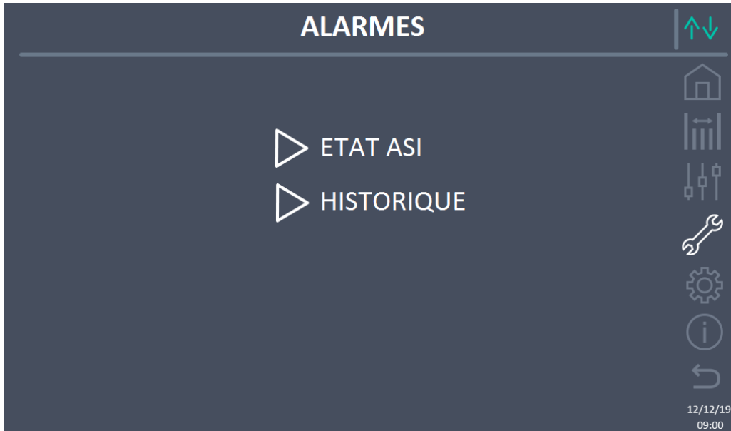
Figure 15 – Section ALARMES (Système)
