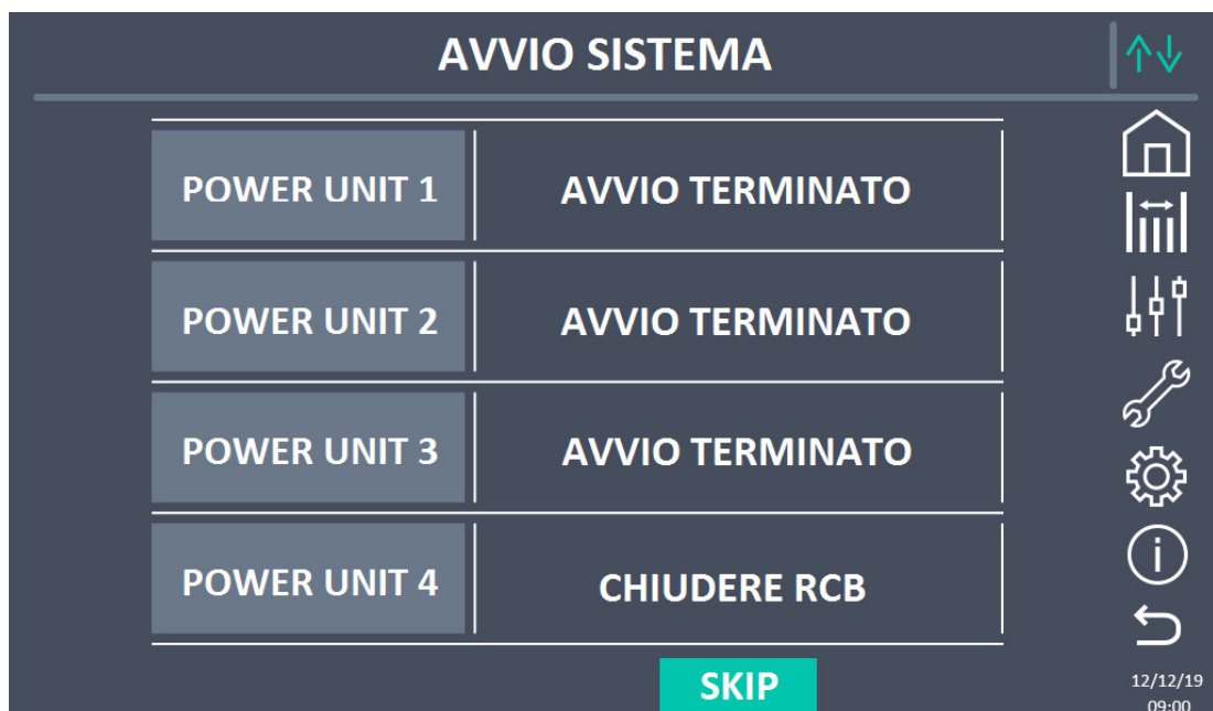
Figura 29 - Schermata avvio terminata per 3 Power Unit su 4
