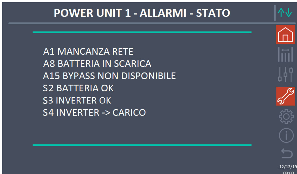
Figura 47 – Sezione ALLARMI - STATO (Power Unit)
