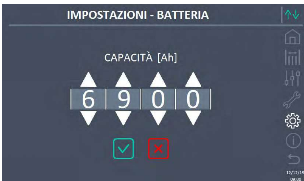
Figura 25 – Impostazione capacità batteria centralizzata
