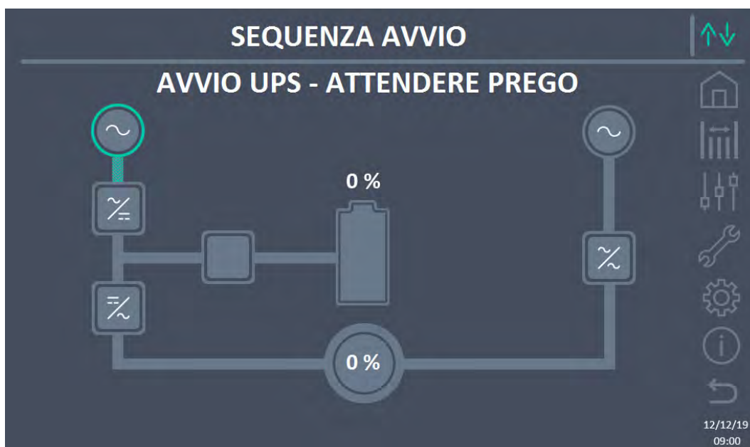
Figura 18 – Avvio da bypass manuale
