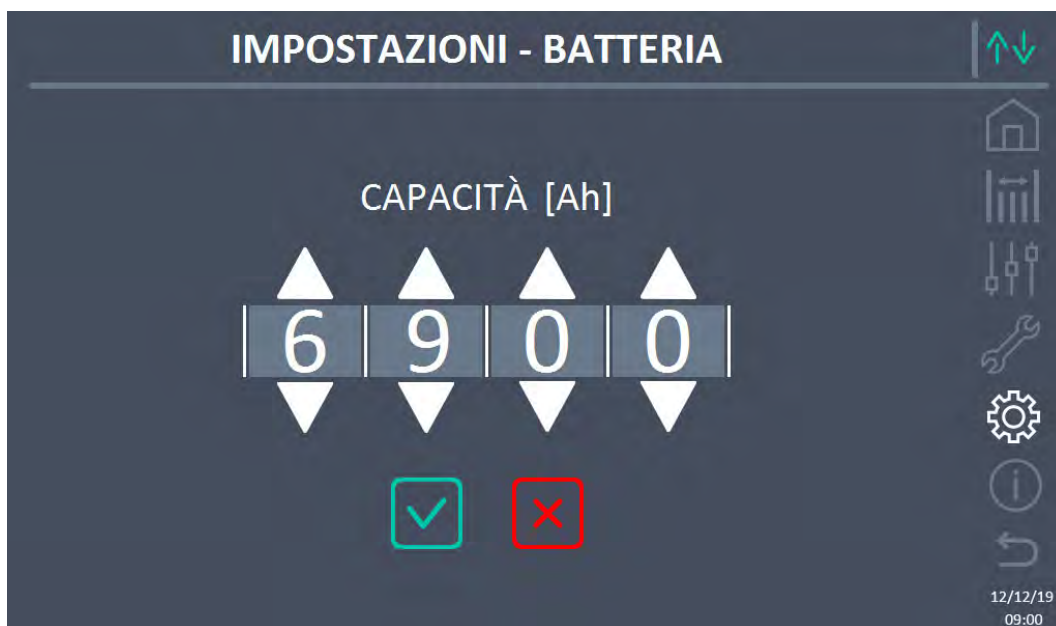
Figura 25 – Impostazione capacità batteria centralizzata
